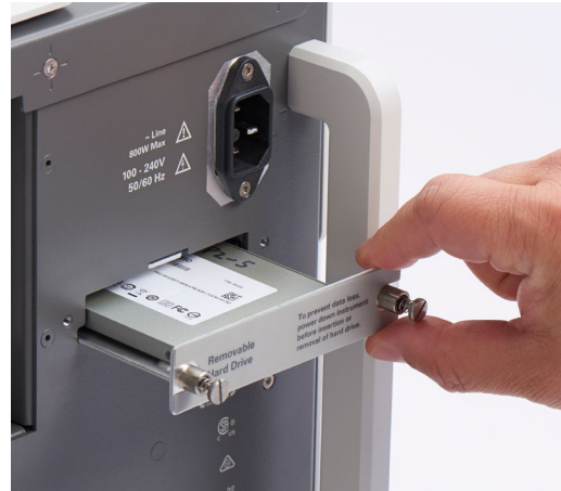
Съемный твердотельный накопитель емкостью 500 Гбайт в стандартной комплектации для быстрой загрузки, повышенной надежности и улучшенной защиты данных.
